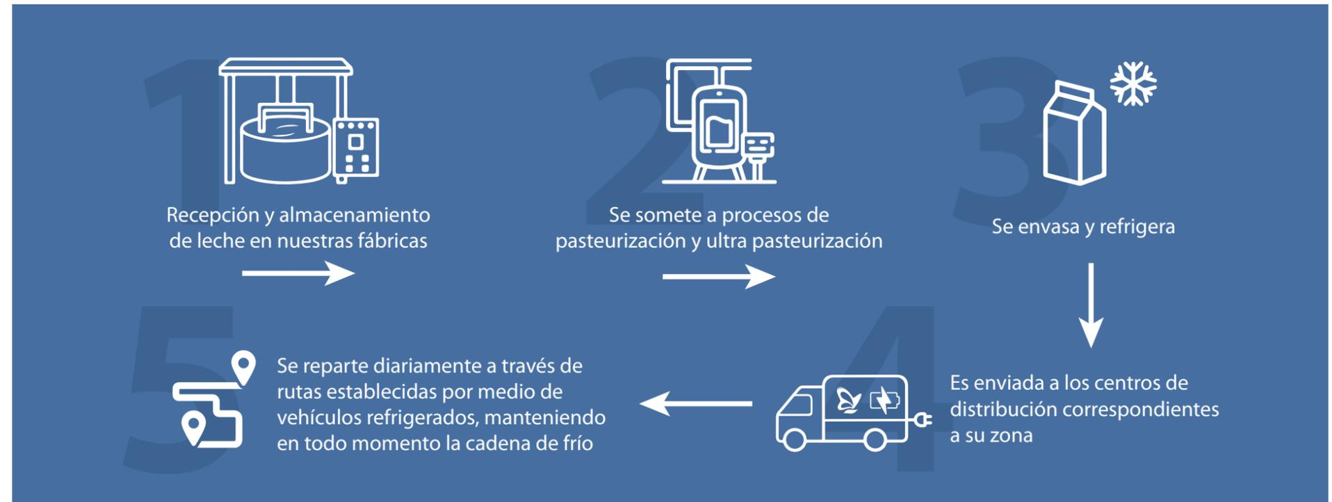
Durante el proceso de envasado utilizamos materiales como cartón (con tecnología Tetrapak y PurePak) y polietileno de alta densidad, así como envases de plástico soplado. Estos últimos y los envases de cartón tipo PurePak se fabrican en nuestras instalaciones en México.
